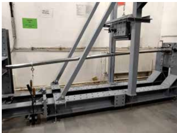
Obr. 2: Ocelová trubka – limit pružného ohybu
