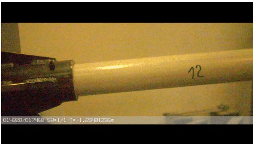
Zpomalené záběry nárazu a řízeného rozvoje trhlin FiberSign TR60x3,0
