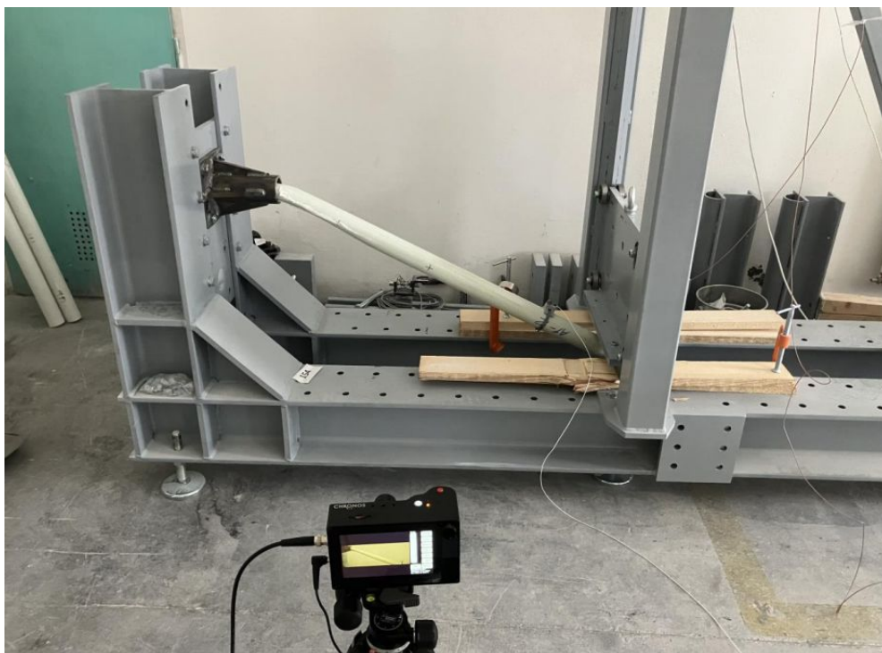
Měření chování sloupku při nárazu
