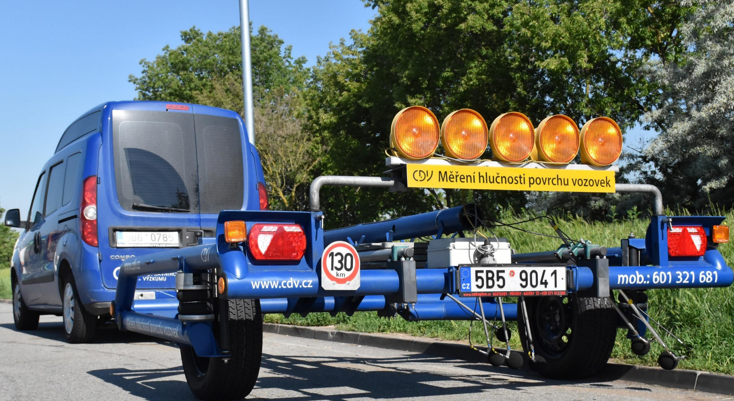
Měřicí systém CPX, aktuální verze
