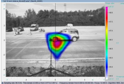
Škoda Yeti (diesel) Příspevek do místa měření AK je L_{Aeq,T} = 48,3 dB.
