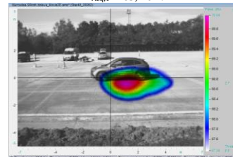
Mercedes EQA 250 Příspěvek do místa měření AK je L_{Aeq,T} = 70,0 dB.
