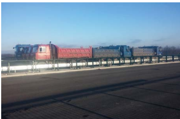
Obr. 17: Fotografie zatěžovací zkoušky ZS21.
