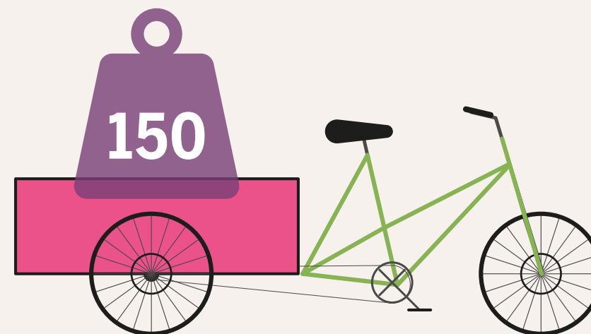
nákladní tříkolka s boxem vzadu (M = 75 kg, MPZ = 300 kg)
